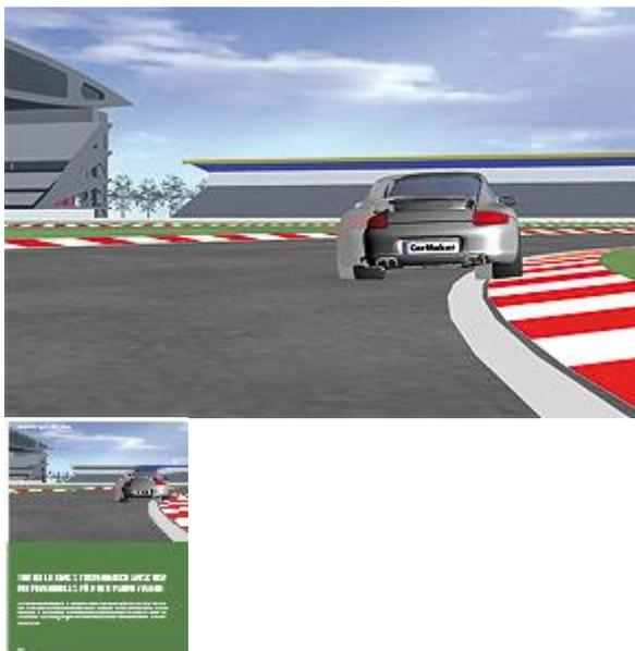
Das von Michelin entwickelte thermomechanische Reifenmodell TameTire stammt aus der Formel 1 und stellt einen Fortschritt in der Fahrdynamiksimulation dar. Das Modell hat IPG in seine Simulationsplattform CarMaker integriert und um neue Funktionen erweitert. Bereits in der frühen Entwicklungsphase kann der Reifen in den Parameterraum der Fahrzeug-Reifen-Interaktion eingebunden werden, sowohl zur Zielerreichung als auch für Toleranzstudien.
