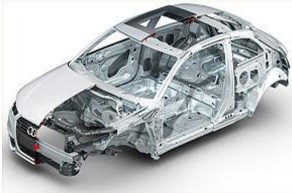
Die Karosserie des Audi A1 ist mit 221 kg ein Leichtgewicht. Besonders der Einsatz alternativer Werkstoffe in den steifigkeitsrelevanten Zonen führte nicht nur zu einer Optimierung der Sicherheit, sondern verbessert auch die Eigenschaften zum Schutz der Umwelt. Besonderheiten wie die Dachkontrastbögen und das Panorama-Ausstelldach machen den Audi A1 in seinem Segment einmalig.
