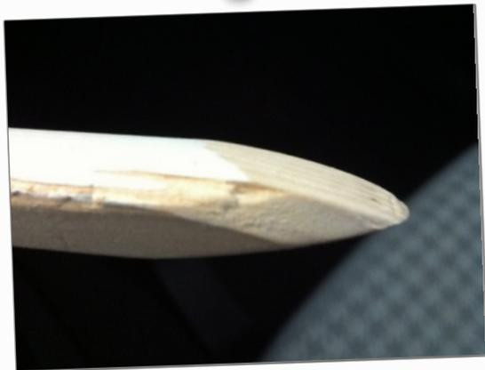
*Das Holz-Stück wird so gefeilt, dass eine Keilform entsteht.*
