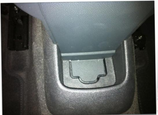
*Die Gummieinlage aus der Mulde der Mittelarmlehnen entnehmen.*
