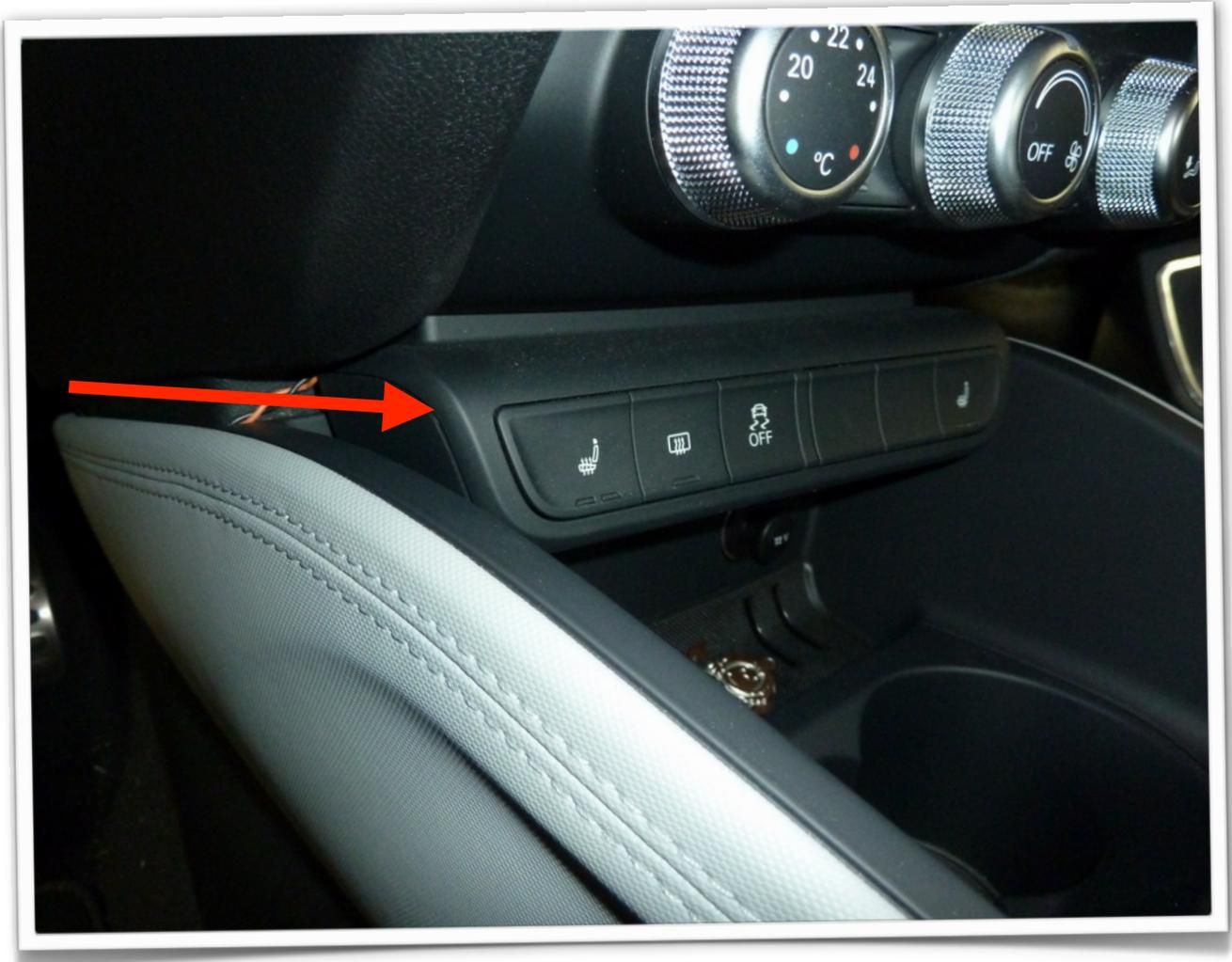
Den Keil in die Fuge (Pfeil) drücken bis die Verkleidung ausrastet. Danach von unten an die hintere Kante der Verkleidung greifen und von links nach rechts aus den Clips ziehen. Zuletzt auf der rechten Seite aushängen und die Verkleidung entnehmen.
