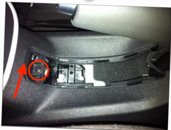
*Den Keil in die Fuge (Pfeil) führen und vorsichtig aushebeln. Danach die Schraube (Kreis) lösen.*
