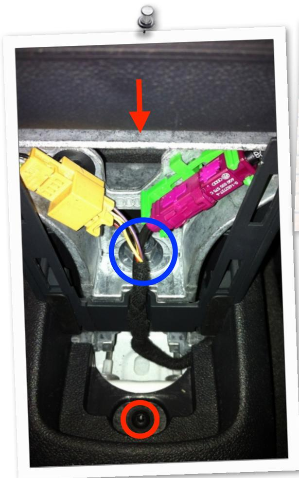
In der oberen Fuge (Pfeil) den Keil reindrücken und raus hebeln (geht ziemlich schwierig). Als nächstes die Steckverbindungen trennen.
