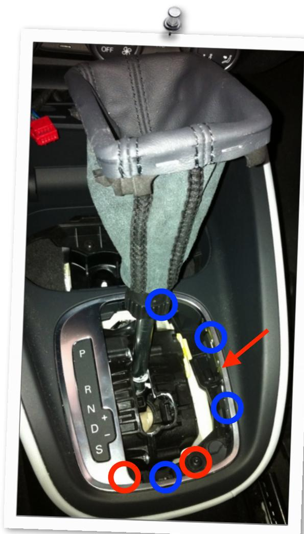
Den Keil zwischen Schaltsack und Rahmen (Pfeil) drücken und gleichzeitig am Leder nach oben ziehen.
