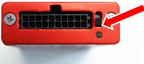
***Achten Sie darauf das sich der Schalter der M-Cantronic in der Position zu LED hin befindet***
