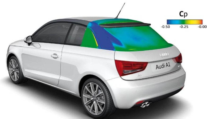
➋ Heckspoiler ohne Spoilerecken: hoher Luftwiderstand und Hinterachsauftrieb
