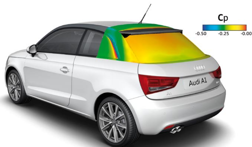
➊ Heckspoiler mit Spoilerecken: geringer Luftwiderstand und Hinterachsauftrieb
