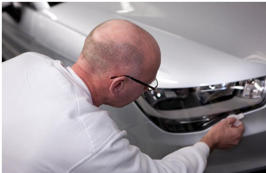
❶ Fugenkontrolle beim A1
